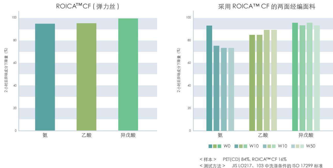
ROICA™CF 中包含具有强效、持久除臭效果的弹力纤维，能有效作用于氨、乙酸、和异戊酸。随纤维加工工序性能会产生变化。
